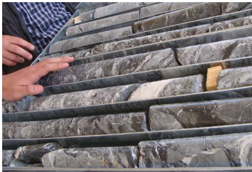
Рис. 3.17 Фотография образцов керна показывает интенсивное проникновение кварц-карбонатных пород (белые) в колчеданной полиметаллической руде.
